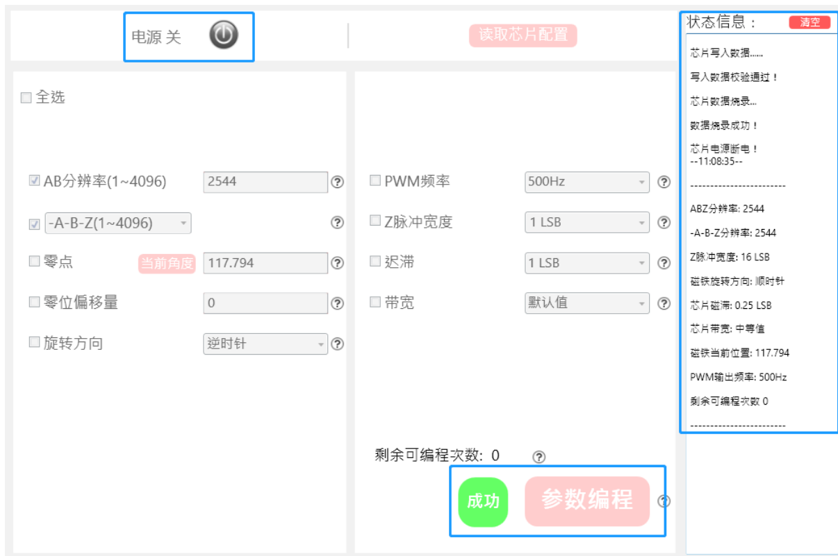
图 4.1.12 芯片电源关闭后的编程界面
