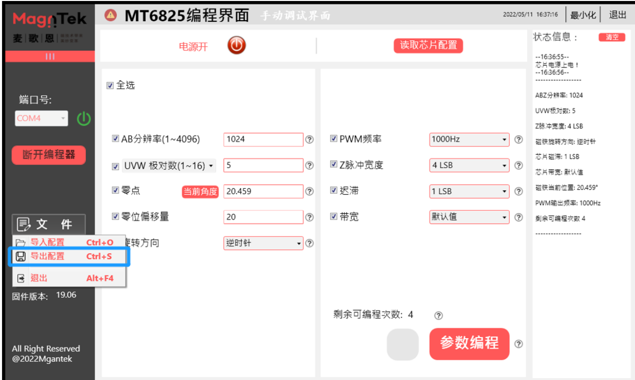
图 4.2.2 设置参数并导出配置信息
